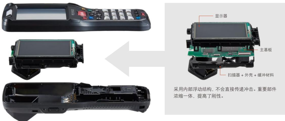
以外壳和缓冲材料将显示器部、扫描器部、主基板等重要零件模块化。设计为模块不特意牢牢固定，从而难以传递冲击的结构。
